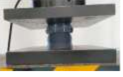
Şekil 3.2. Deney parçalarının eksenel basma testi altındaki katlanma davranışları II
