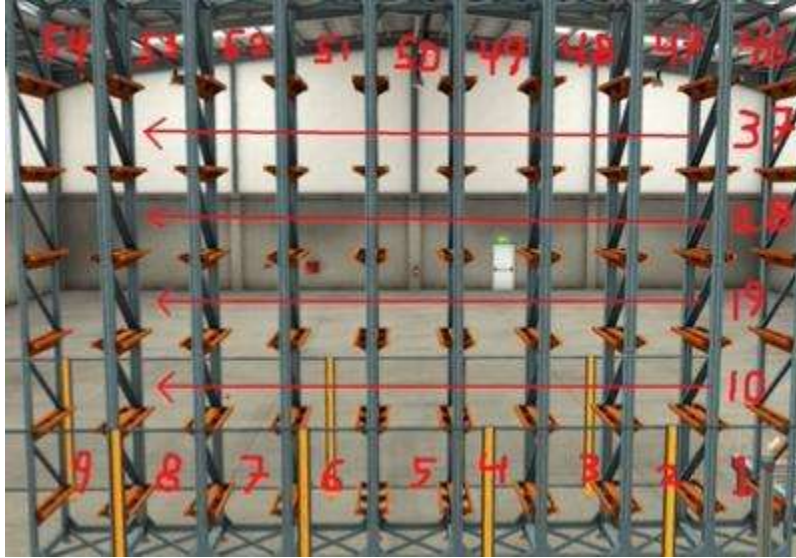
Şekil 2. 9x6 AS/RS Raf Yapısı – Factory I/O Görünümü
